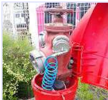
Clipser le logger LP025 sur le flexible. Finir ensuite d'ouvrir la vanne, tout en s'assurant de l'absence de fuite. Pour terminer, glisser le logger sur le coté du poteau d'incendie.
